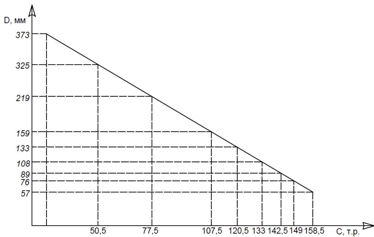
Рисунок 7.7 – Зависимость стоимости одного m^2 материальной характеристики от диаметра трубопровода
